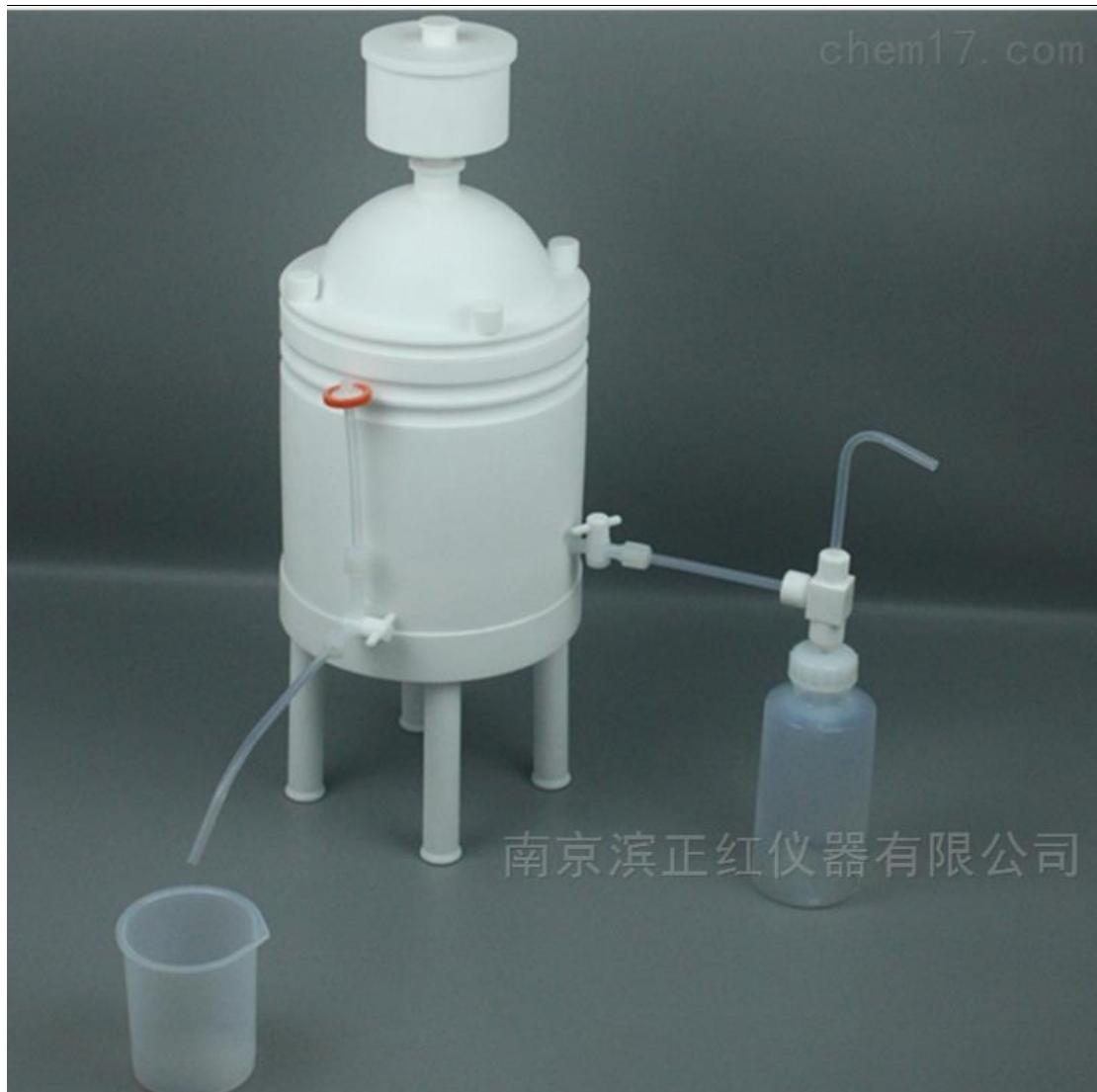
Con este Sistema se obtienen ácidos de alta pureza: utilizando el modo de destilación a sub-ebullición, manteniendo la temperatura del líquido en el recipiente por debajo de la temperatura de ebullición, evaporándose y luego condensándose. El consumo de energía de funcionamiento ultrabajo es un método más económico y rápido para preparar ácido de alta pureza.
